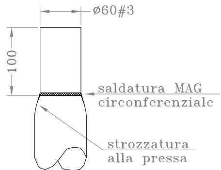
Particolare lavorazione cima palo
